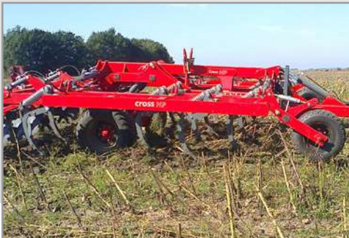
4-х рядне розміщення зубів - відстань між рядами 750 мм відстань під рамою 850 мм гарантує роботу без забивання
