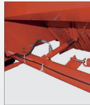
Гідравлічне регулювання підбирача (опція) - дозволяє управляти підбирачем з кабіни трактора
