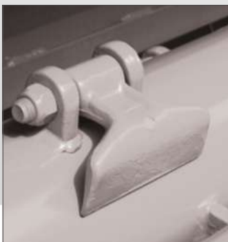
Робочі органи - МОЛОТКИ KORNIK L - вага молотка 700г KORNIK XL - вага молотка 1650г
