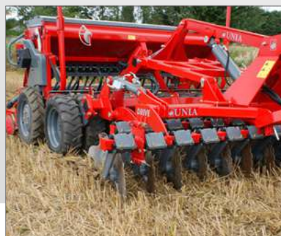
System Drive Агрегат можна замовити з шинним валом, який робить можливим транспортування, а також вирівнює та прикатує землю під час роботи
