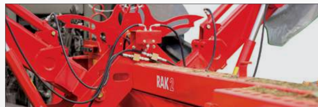
Блокування роторів в транспортному положенні
