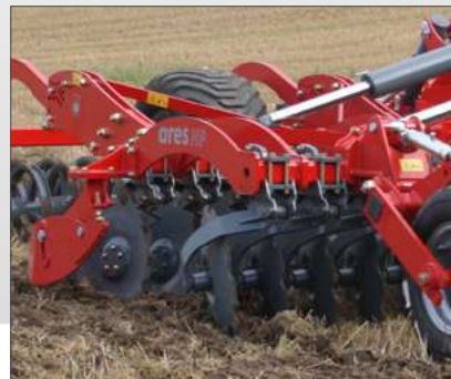
Діаметр та тип дисків забезпечують якісне підрізання та перемішування з ґрунтом великих кількостей рослинних залишків
