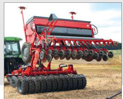
Навіска сівалки - дана опція використовується для створення компактного ґрунтообробно-посівного агрегату
