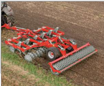
ARES LONG включає ряд лап, які забезпечують розпушення ґрунту до 25 см
