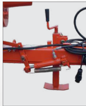
Гідравлічне регулювання дисла (опція) - полегшує переведення машини в транспортне положення і навпаки
