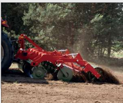
Вал кільцевий - рекомендований для липких та важких ґрунтів
