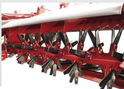
Надійна міцна конструкція. Захист дисків. Швидка заміна ступиць дисків і ножів.
