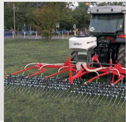
Борону можна додатково укомплектувати пневматичною сівалкою для сидератів ЕТА
